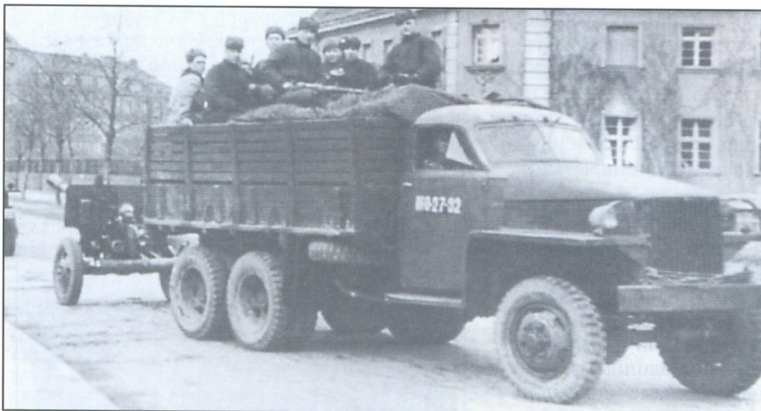
Автомобиль Красной Армии "Студебеккер" US6 буксирует 76-мм дивизионную пушку
