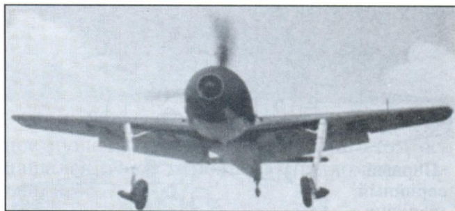
FW 190V1 в полете. Хорошо видны небольшие размеры крыла первого опытного самолета
